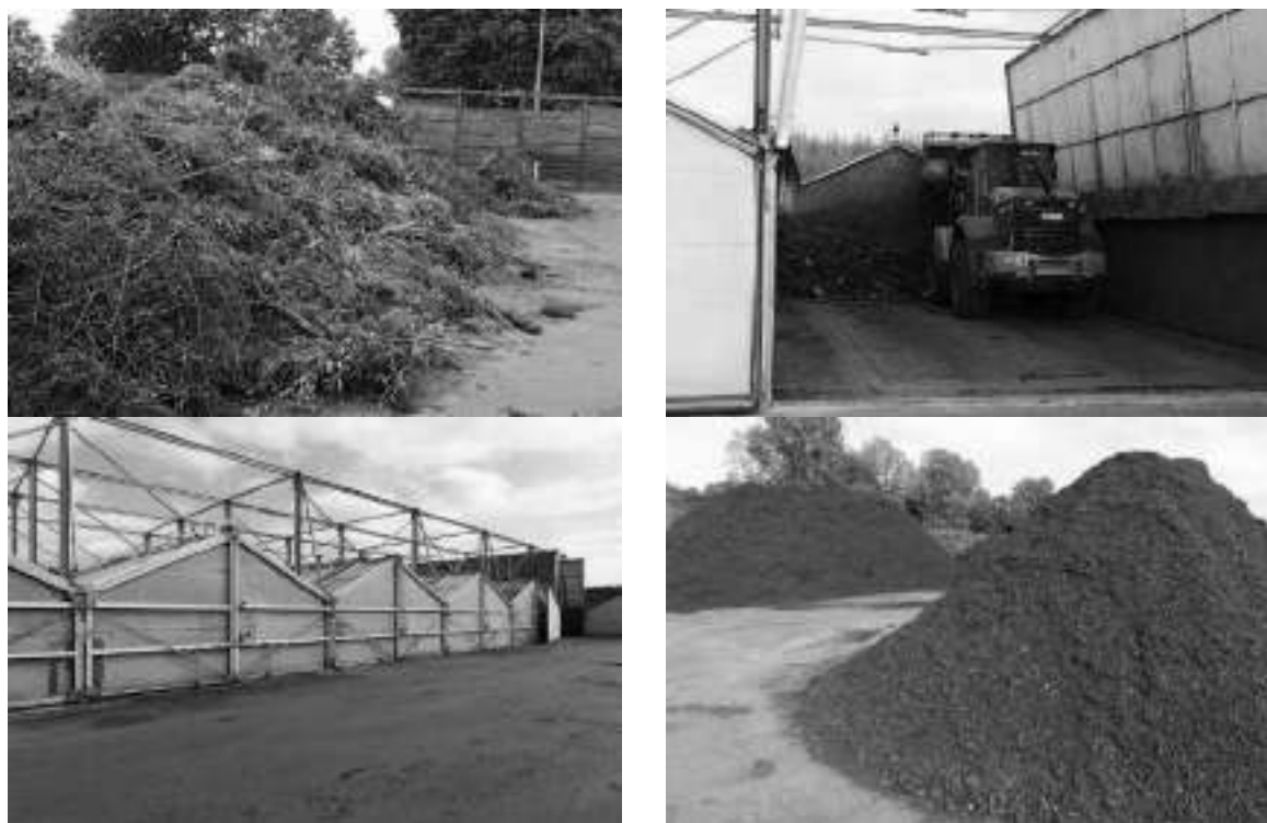
Figura 22 Shembull i një impianti kompostimi me ajrosje artificiale: materiali i sjellë, mbushja e kontenierëve me ajrosje, kompostimi në kontenierë, komposti i situar 47
