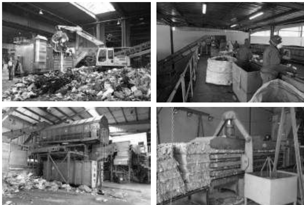
Figura 16 Elementët e IRM: Bunkeri/ hapësi i qeseve, ndarja me dorë, sita, presa 39
