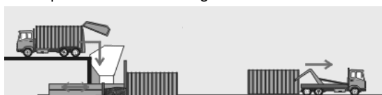
Figura 15 Parimet e ngarkimit të drejtpërdrejtë me dhe pa ngjeshje në stacionet e transferimit 38
