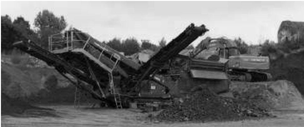
Figura 23 Shembull i një impianti të lëvizshëm për trajtimin e MNP 48
